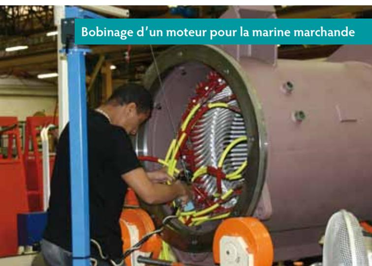
Bobinage d'un moteur pour la marine marchande
