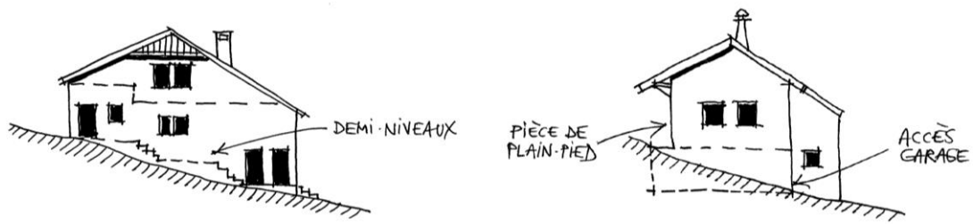
Exemples d'implantations conseillées : adaptation de la maison au relief naturel du terrain.
